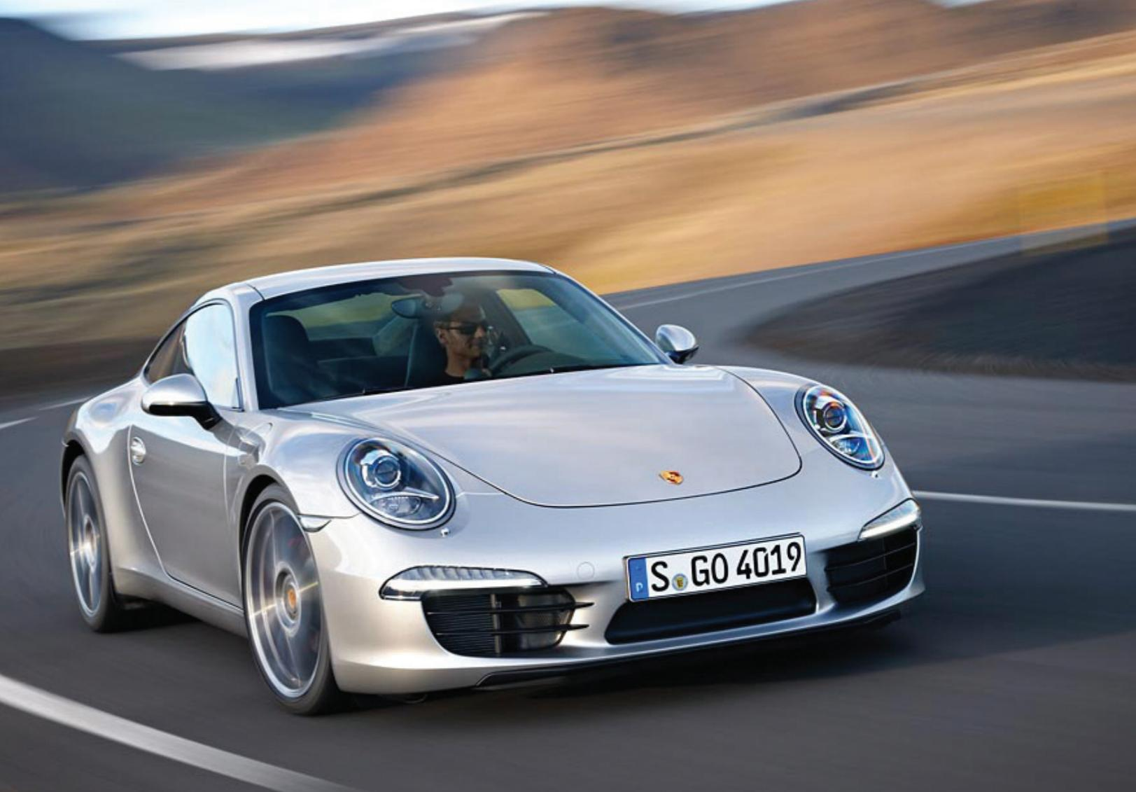
снижение массы автомобиля. И это при значительном увеличении жесткости. Благодаря оптимизации аэrodинамики — в том числе благодаря наличию более широкого заднего спойлера, который может выдвигаться на разную высоту — удалось еще дополнительно снизить подъемную силу нового 911 Carrera при сохранении очень хорошего значения коэффициента аэродинамического сопротивления  $C_w$ .
